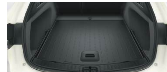
Piano di carico double face (lato resina dura)
